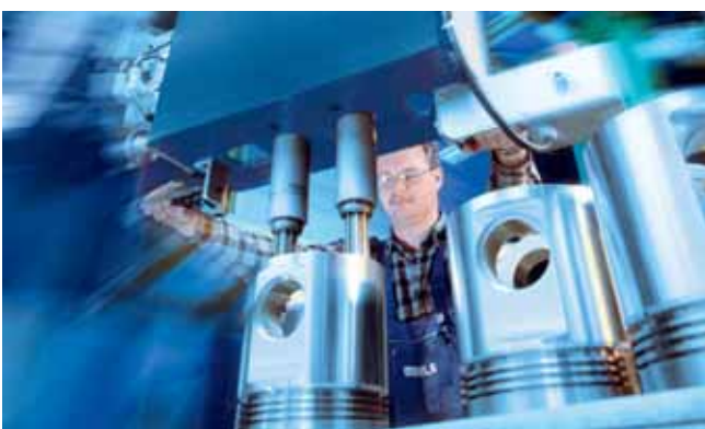
Elektronisch gesteuertes Anziehen von Kolbenschrauben in der Endmontage
